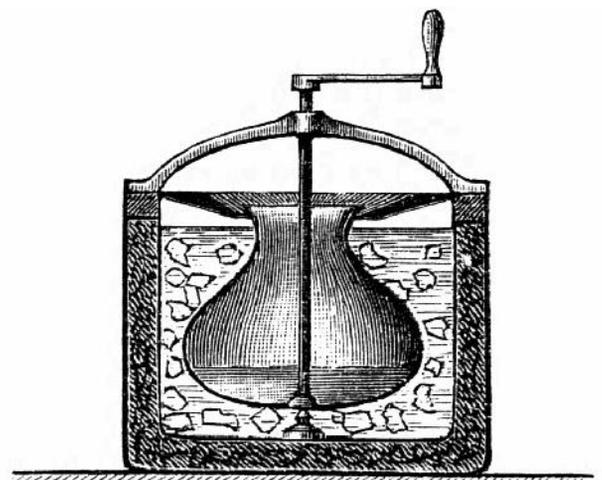
▲ Abb. 45: Eismaschine, um 1894.
